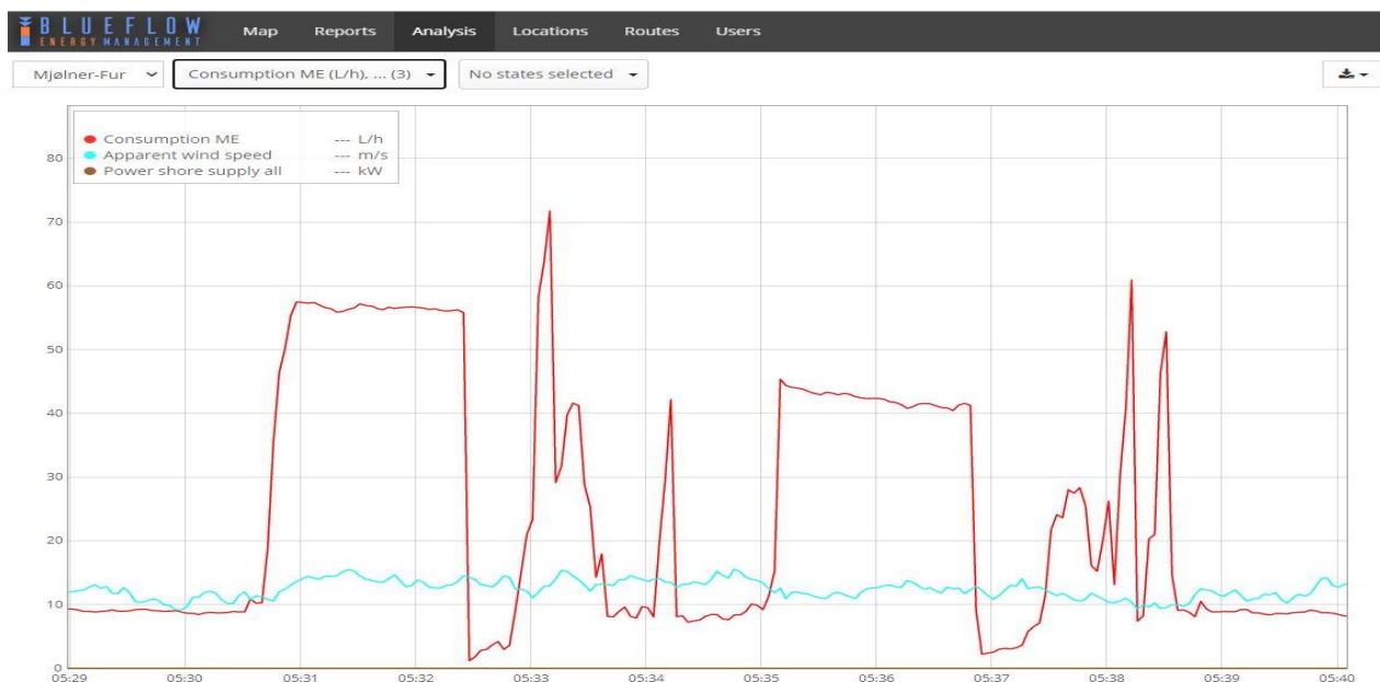
Figur 4: Udtræk fra Blueflow systemet – driftsprofil, dobbelttur "Mjølner"
